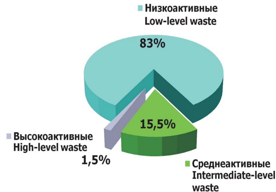
Рис. 3. Соотношение накопленных твердых РАО по категориям Fig. 3. Distribution of Accumulated SRW by Categories
