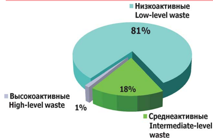
Рис. 4. Соотношение накопленных жидких РАО по категориям Fig. 4. Distribution of accumulated LRW by categories
