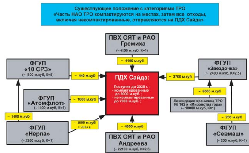
Рис. 2. Интегрирующий подход решения проблемы обращения с НАО ТРО в регионе (фрагмент, K – коэффициент компактирования)
